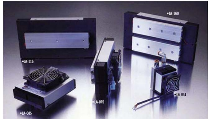
Mit Ausnahme des LA-024-12-02 haben alle Liquid-to-Air Systeme eine in den Luftkühlkörper eingebaute Bi-Metall Temperatursicherung, die bei Überhitzung ab +75°C den Peltier-Stromkreis unterbricht.
