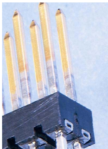
Stiftleiste mit Lot-Flussmitteldepots Header with solder-flux preforms
